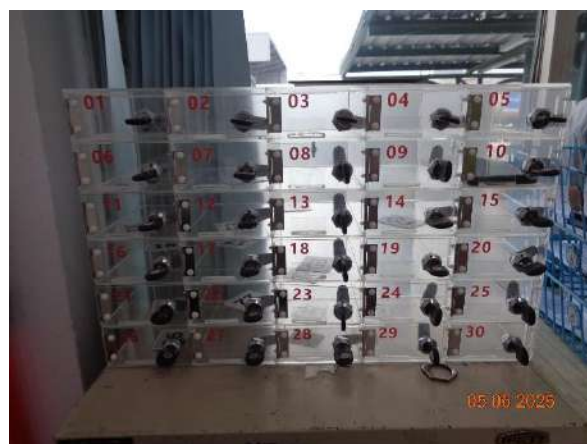
ภาพที่ 2.2-33 ตู้เก็บสิ่งของที่ทำให้เกิดประกายไฟ
